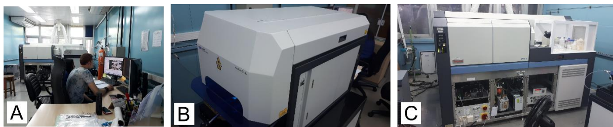
Figura 11. Operação no LA-ICP MS: A) Escolha dos pontos que foram atingidos pelo laser; B) Aparelho portador do laser que desgastou os pontos escolhidos na superfície dos zircões; C) Espectrômetro de massa, onde ocorre a medição das razões.
