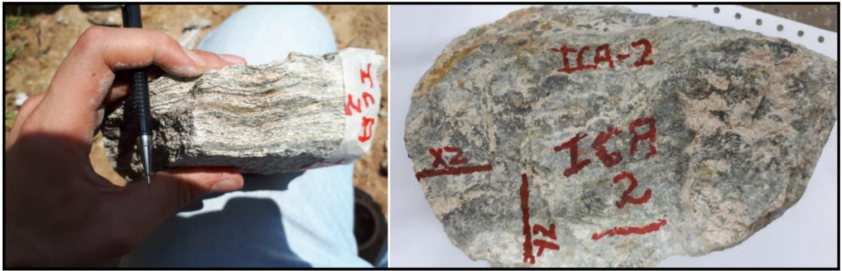
Figura 2. Exemplo da identificação realizada em cada amostra coletada e da determinação do plano de corte para laminação. Neste caso a amostra ICA-02, que se trata de um muscovita gnaiss bandado, pertencente ao Complexo São Miguel. UTM 22J 738347/ 7032945.
